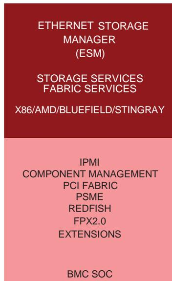
其韧体存在于板上的BMC内且除了保有MegaRAC® SP-X™完整服务器管理功能外，还包含MegaRAC FPX2.0扩充功能以提供安全频外的NVMe储存装置管理能力。所有管理功能在安装后可立即使用。此解决方案的软件部分称为Ethernet Storage Manager (ESM)。其可运行于储存服务器的芯片组，或运行于被储存应用盒(JBOFs)采用的RNIC ARM CPU核心。
